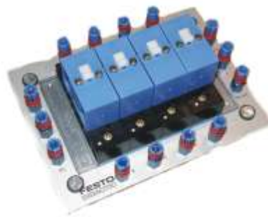
Rys.12.5 Jednostka taktowo-stopniowa: a) schemat funkcjonalny, b) schemat blokowy, c) wygląd jednostki
